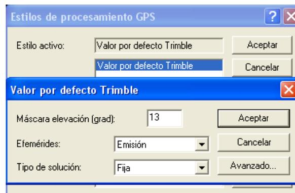
Máscara de elevación (grad): establece la máscara de procesamiento. 13° es el valor por defecto. Puede modificarse según necesidad.
